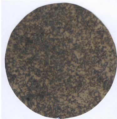
Figura 2.23.- Estructura esferoíridizada de un acero con 1 % de C
