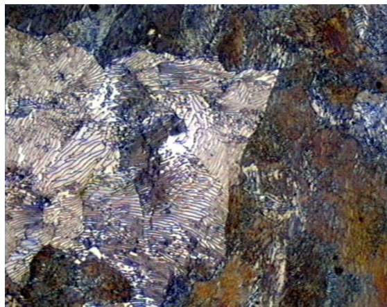
Figura 1.5.- Perlita en un acero eutectoide
